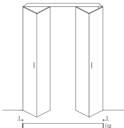
Sistema di chiusura a pacchetto per nicchie e cabine armadio con ante sp. mm 19 realizzate in mdf, laccate liscie con struttura sp. mm 19 X 100 completo di cerniere e meccanismo di scorrimento.
