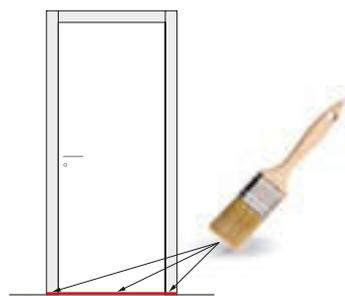
Resina trasparente + catalizzatore da applicare su teste pannello, telaio, coprifili. Le parti inferiori sensibili di telaio cassa, coprifili e pannello porta, possono essere completamente impermeabilizzate, utilizzando un sottile strato di silicone o semplicemente resina poliuretanica trasparente monocomponente, da applicare a pennello o rullo in modo veloce e semplice a totale sigillatura delle parti più esposte a contatto con l'umidità.
